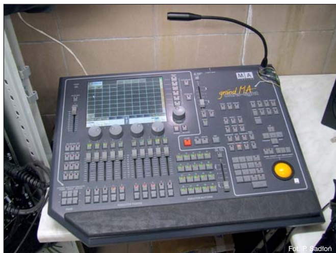
Całym pokazem (światło, woda, projekcja, laser) można również sterować „ręcznie”, za pomocą konsoli grandMA ultra-light.
