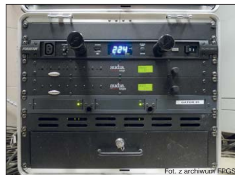
Cztery mobilne raki sprzętowe zawierają: 8 systemów bezprzewodowych, źródła muzyczne (odtwarzacze, rejestratory), 8 bezprzewodowych systemów dousznych i moduły z wejłwiy analogowymi AudiaEXPI i AudiaEXPO.
