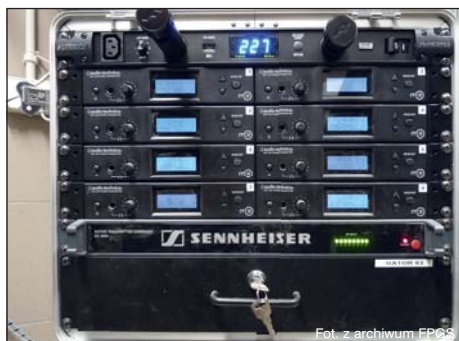
Cztery mobilne raki sprzętowe zawierają: 8 systemów bezprzewodowych, źródła muzyczne (odtwarzacze, rejestratory), 8 bezprzewodowych systemów dousznych i moduły z wejłwiy analogowymi AudiaEXPI i AudiaEXPO.
