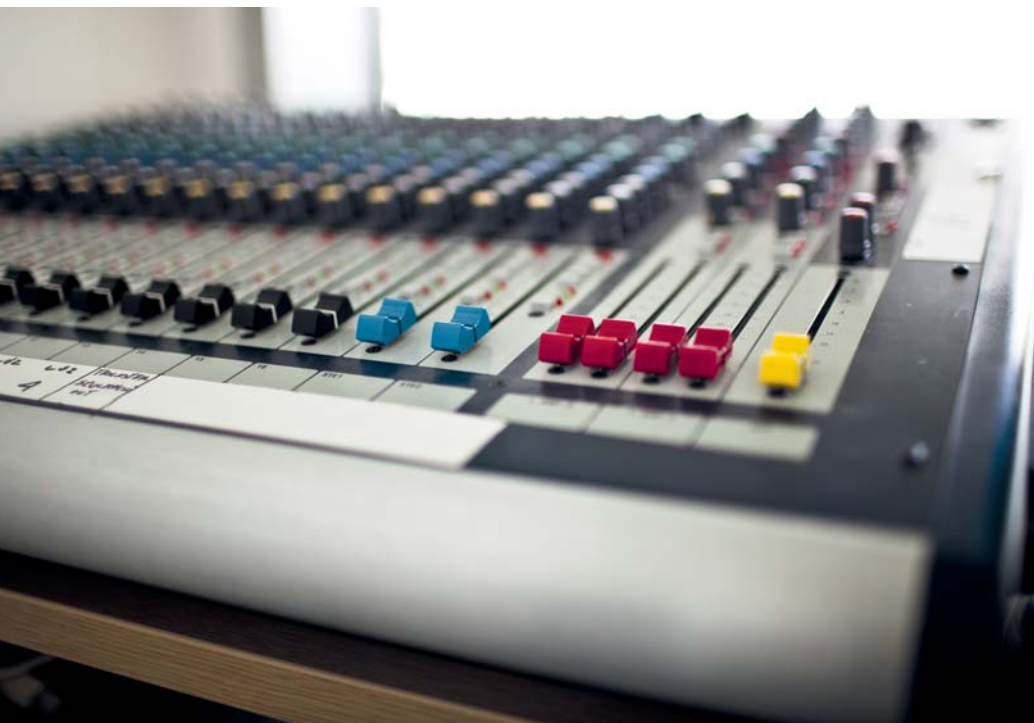
W reżyserce pracuje mikser Soundcraft GB 4/16, do którego podłączone są peryferia – w tym cyfrowe odbiorniki bezprzewodowe AKG DSR700, odtwarzacze i rejestratory CD/DVD oraz Blu-Ray.
